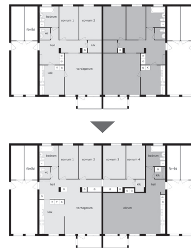
⑤筆者によって2住戸の改築がなされた事例。上図が改修前平面、下図が改修後平面。多子世帯のための住戸(薄いグレーの部分)と小規模世帯の住戸(濃いグレーの部分)へ再編されている
