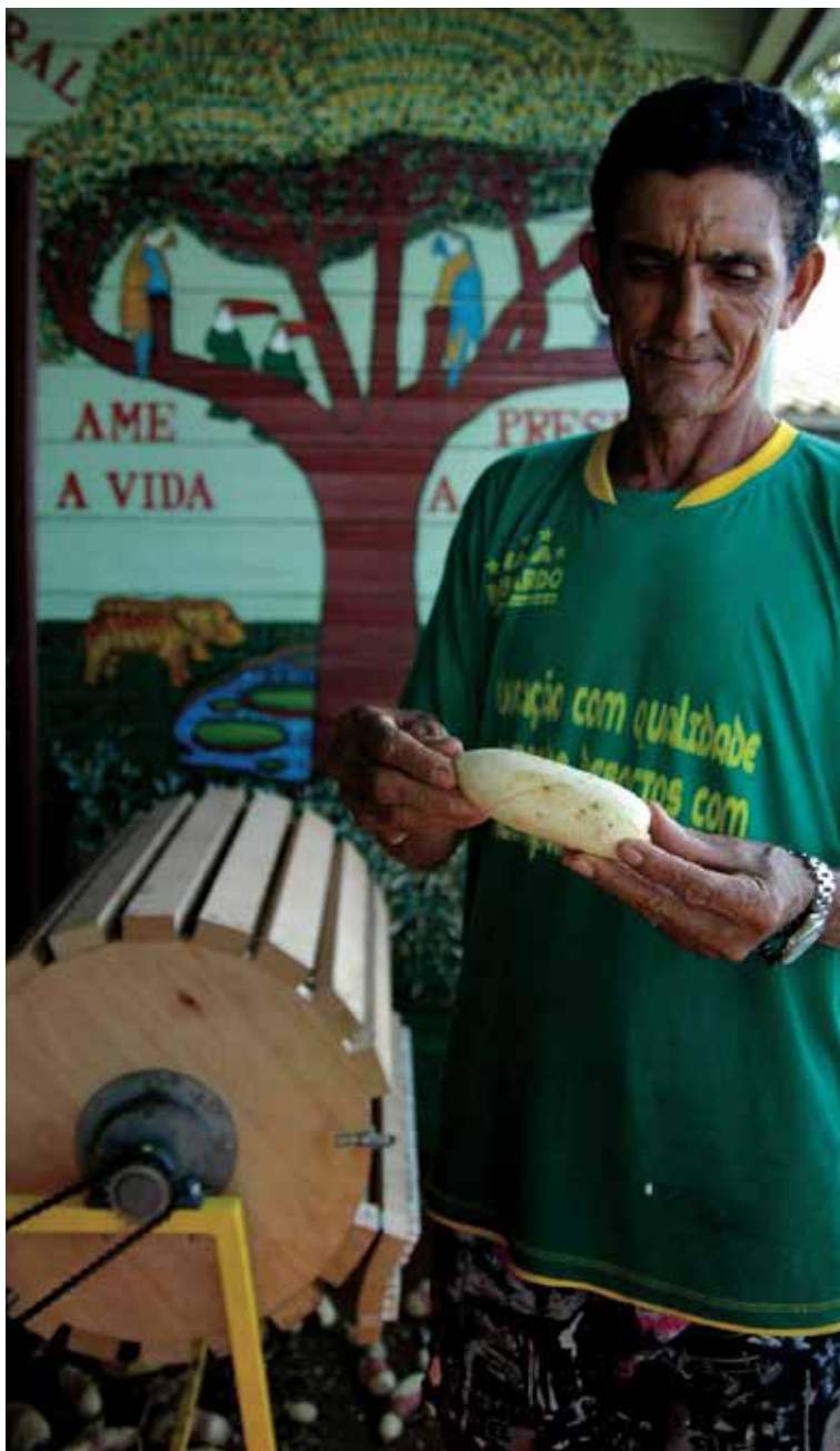
En cassava skalad med hjälp av den utvecklade pedaldrivna maskinen.
