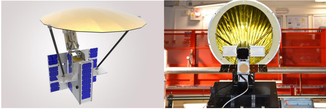
Figur 5: Utfällbar reflektorantenn för nanosatellit, https://www.nslcomm.com .
