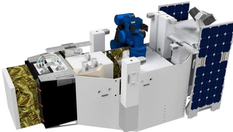
Figur 6: Archinaut One för additiv tillverkning i rymden, https://madeinspace.us .
