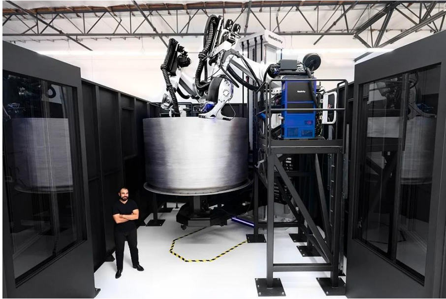
Figur 4: Additiv tillverkning av en hel raketstruktur, https://www.relativityspace.com .
