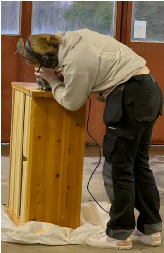
Bild 11: Kapning av dekorationslister.
