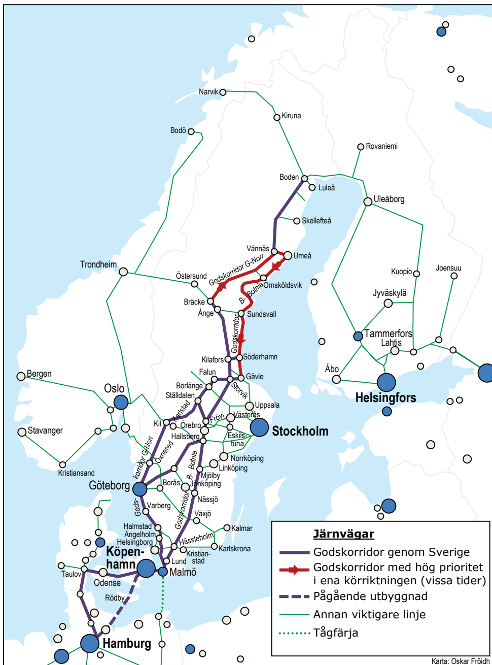
Figur 37. Del av godskorridorerna genom Sverige där enkelriktning av godstrafiken vissa tider skulle ge stora kapacitetsvinster.
