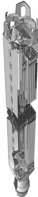
Figure 8.1: Ett kärnbränsleelement från en kokvattenreaktor. Bränslets längd är cirka 4 m med ett tvärsnitt om cirka 140 \times 140 \text{ mm}^2 . Vikten är omkring 200 kg.
