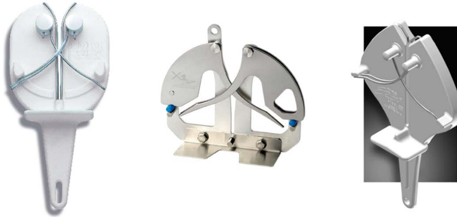
Figur 8. Olika typer av krysstål. Stålen består av korslagda fjädrande metallstål som är böjda för att ge konstant stålningvinkel. Skåran har till funktion att styra upp knivbladet så att det stålas symmetriskt. Ramen kan vara av stål eller plast (Dick, Dassaud Fils, Cozzini Prime Edge).
