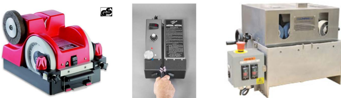
Figur 5. Slipmaskiner med inställbar slipvinkel (Dick, TruHone, Cozzini Prime Edge)
