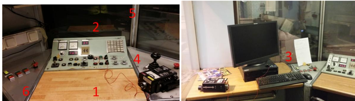
Figur 9. Mätpunkter för belysningsmätning i operatörshytt.
