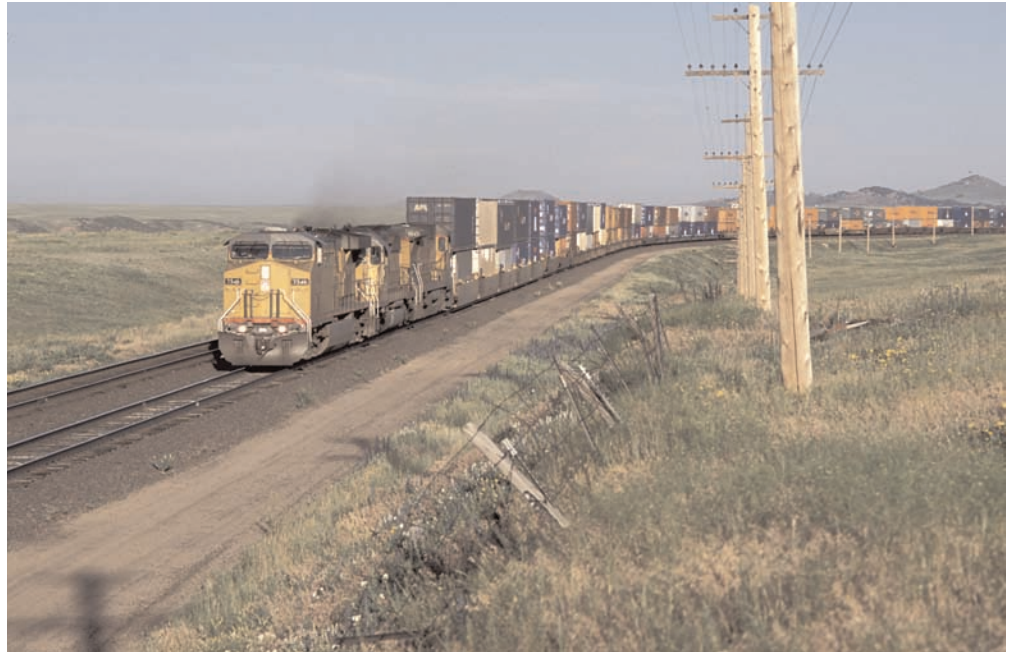
... såväl som containertåg med två våningar containrar på vagnarna (double-stack).
