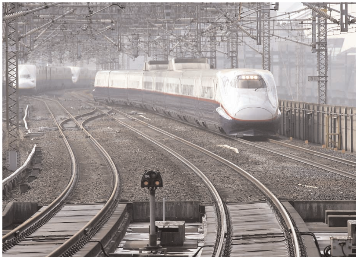
Shinkansentågen i Japan är breda och lätta motorvagnståg och därmed energieffektiva trots att de går i upp till 300 km/h.
