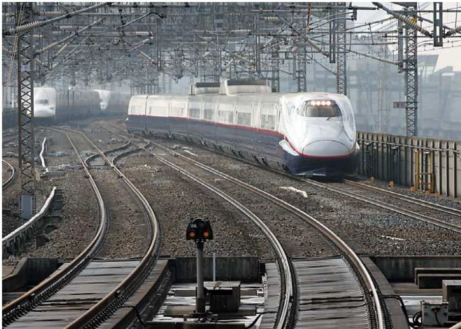
Bild 7 JR East tågsätt typ E2. I bakgrunden skymtar två multipelkopplade E4 "Max". Foto: Oskar Fröidh
