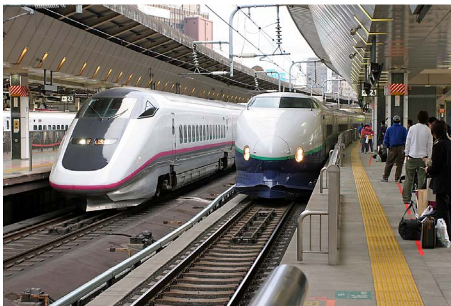
Bild 5 Smalt eller gammalt? Tågsätt med smal profil serie E3 till vänster. Till höger en äldre serie 200-tåg som här används som långväga regionalståg när nya tåg tagit över de snabbaste förbindelserna: Foto: Oskar Fröidh
