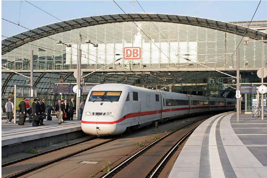
Bild 11 ICE1 och ICE2 liknar varandra, men medan ICE1 har drivenheter i båda ändar har ICE2 en manövernagn i andra änden liksom X2. Foto: Oskar Fröidh
