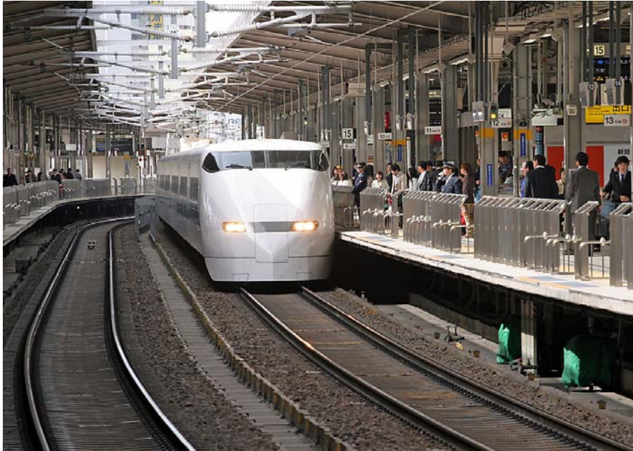
Bild 6 Serie 300 var de första Shinkansen-tågen i en ny generation lättviktståg med asynkronmotorer, med första leverans 1989. Foto: Oskar Fröidh
