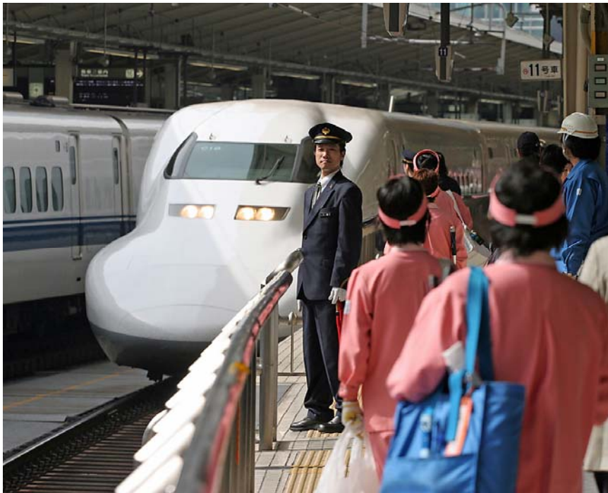
Bild 8 Serie 700 har en lång nos för att minska luftmotståndet. Foto: Oskar Fröidh
