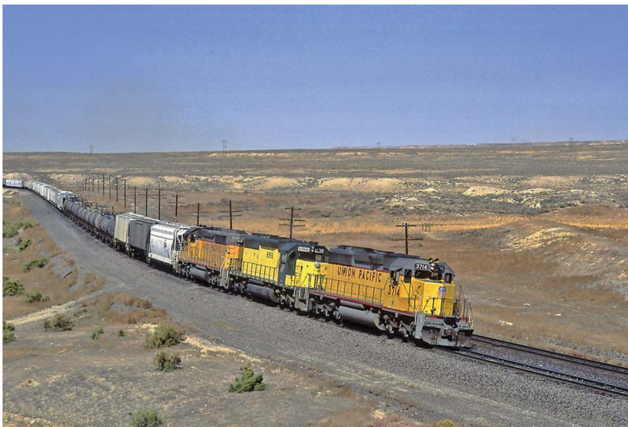
Godstågen i USA kan vara 2-3 km långa med en bruttovikt på 10 000–15 000 ton, har automatkoppel och oftast flera lok.
