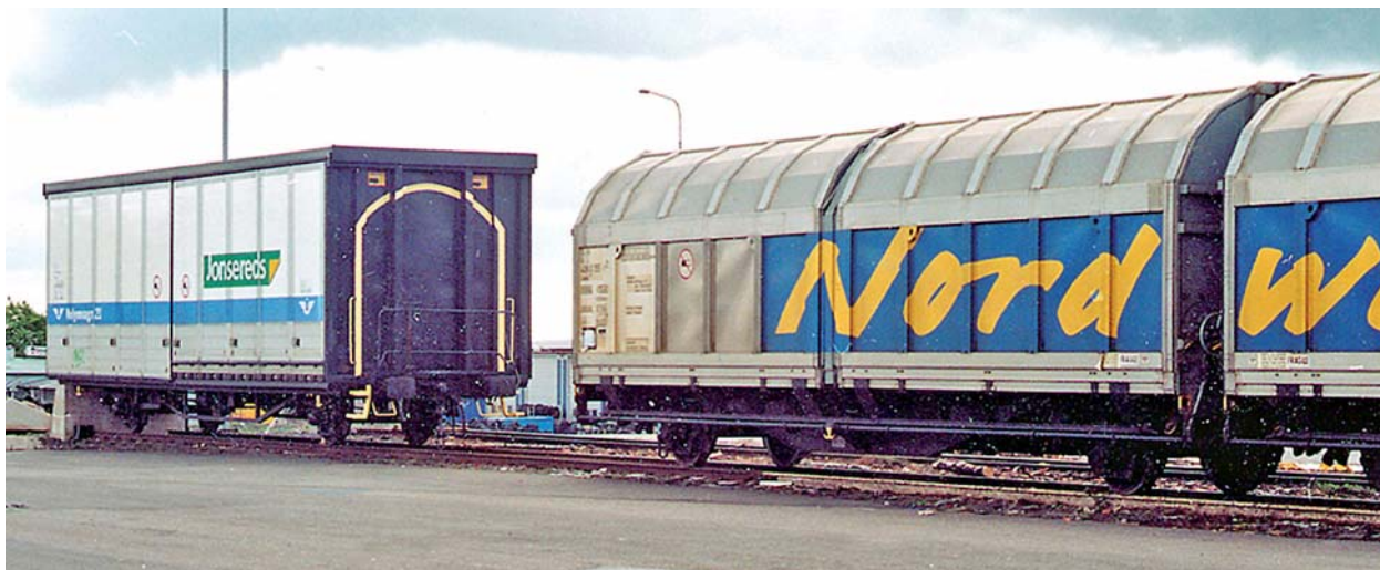
20 En större lastprofil som också är fyrkantig utan avrundade hörn är viktig för att minska transportkostnaden för volymgods. Bilden visar en vagn med lastprofil C jämfört med den normala lastprofilen G1.
