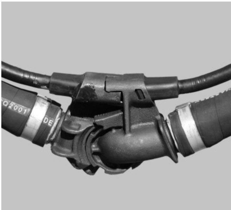
Figur 17 Piggyback integrerad slangkoppling och skarvdon för Train Line kabel
