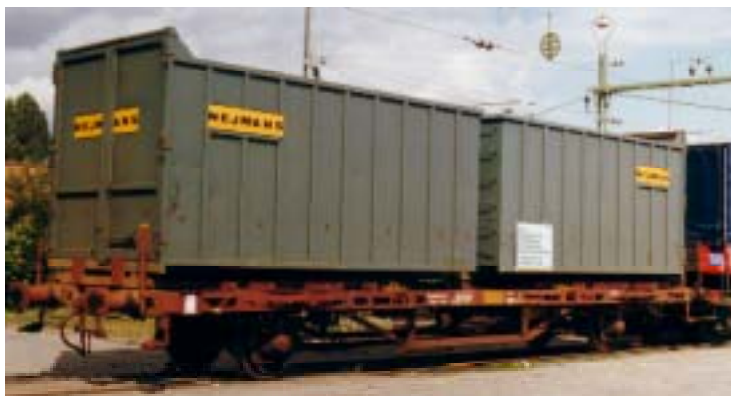
Bild 5.14 Järnvägsvagn försedd med vridbara lastramar för rullflakshantering. Vagnen är lastad med två rullflak
