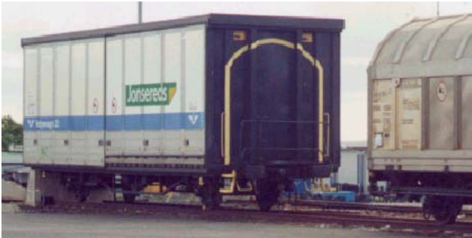
Bild 3.2 Prototyp (Volymvagn 21) som utförts enligt lastprofil C
