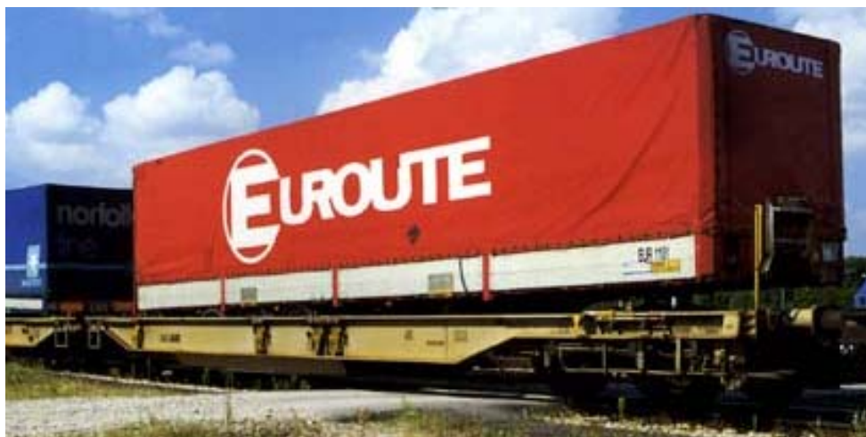
Bild 5.23 Ledad kombivagn typ Sdggmrss, som används för transport av två påhängsvagnar eller containers och växelflak upp till klass A (Bild: AAE)
