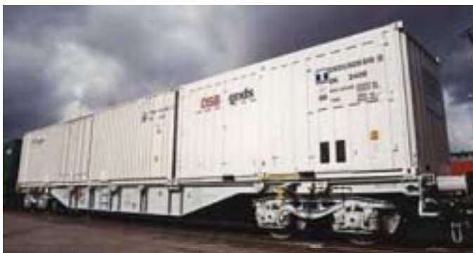
Bild 5.26 Boggivagn typ Sgnss, avsedd för transport av två växelflak klass C respektive C+ alternativt två containers klass C eller en lastbärare klass A (Bild: AAE)
