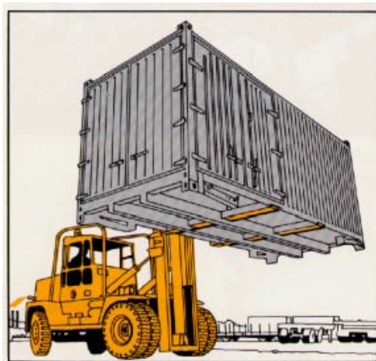
Bild 5.8 Hantering av växelflak med hjälp av gaffeltruck (Bild: SJ Frakthandbok 1988-04)
