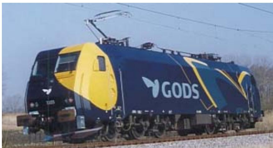
Bild 3.8 DSB / Railion lok typ EG 3100 ("Öresundslök")
