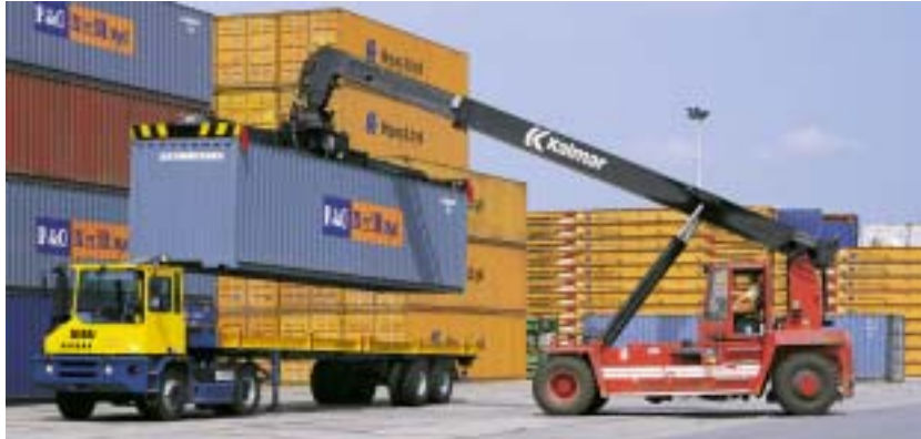
Bild 5.12 Topplyftning av container med truck (Bild: Kalmar Industries)
