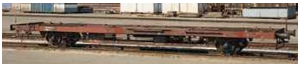
Bild 5.24 2-axlig vagn, typ Lgns, avsedd för transport av två lastbärare klass C respektive en lastbärare klass C+ eller A (Bild: Green Cargo)
