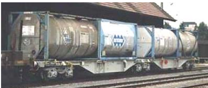
Bild 5.27 Ledad 6-axlig boggivagn typ Sggmrss, avsedd för transport av fyra lastbärare klass C respektive C+ eller två lastbärare klass A (Bild: AAE)
