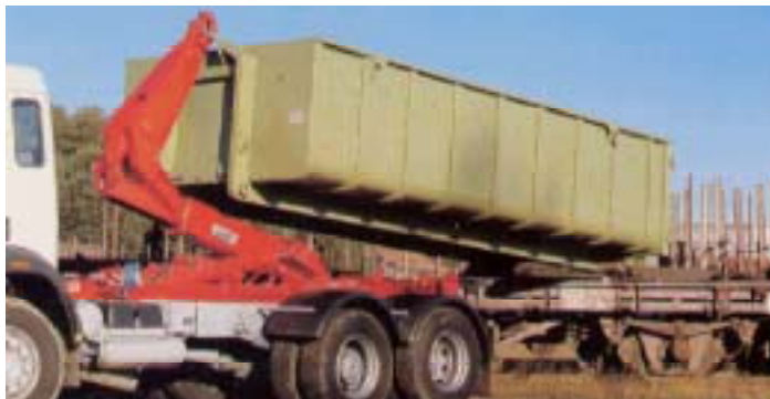
Bild 5.13 Direktöverföring av rullflak mellan lastbil utrustad med lastväxlare och järnvägsvagn försedd med vridbar lastram (Bild: Hiab)
