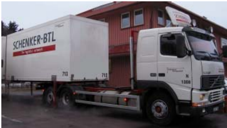
Bild 5.2 Stödbensflak som hämtas av eller ställs av från lastbil (Bild: Schenker)
