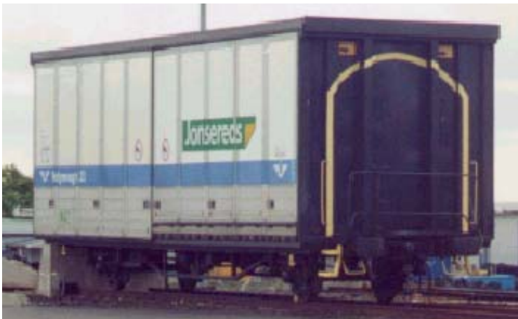
Bild 4.4 Prototyp till Hbins-vagn som utförts enligt lastprofil C (Volymvagn 21). Observera att tvärsnittet hos en Hbbins i stort överrensstämmer med den gula randen på vagnens gavel.
