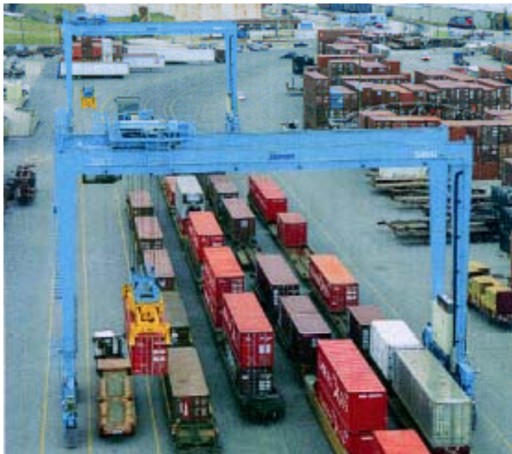
Bild 5.11 Portalkranar för hantering av containers och påhängsvagnar vid kombiterminal (Bild: Kalmar Industries)
