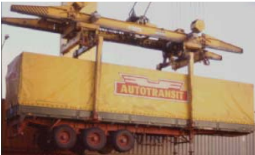
Bild 5.4 Griparsyftning av påhängsvagn i dess hörnbeslag
