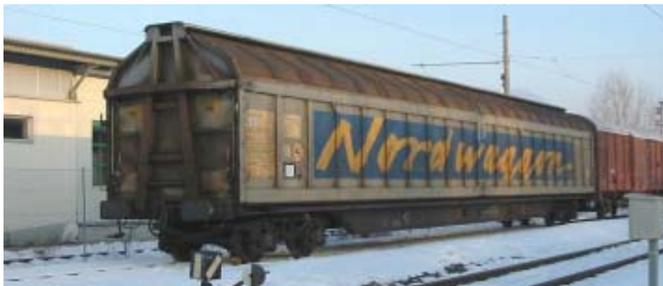
Bild 3.4 Boggivagn av typ Habins (Bild: Salzburger Lokalbahn)
