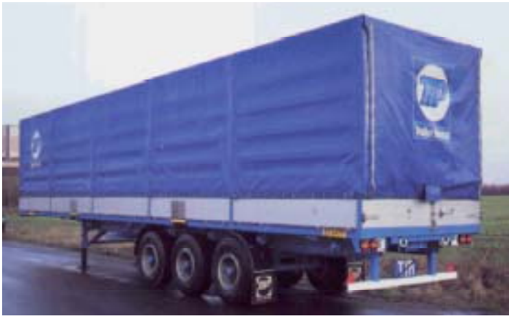
Bild 5.3 Påhängsvagn med lyftbeslag för kombitransport (gula markeringar över stödben respektive mittaxel) (Bild: TiP Trailer Rental)
