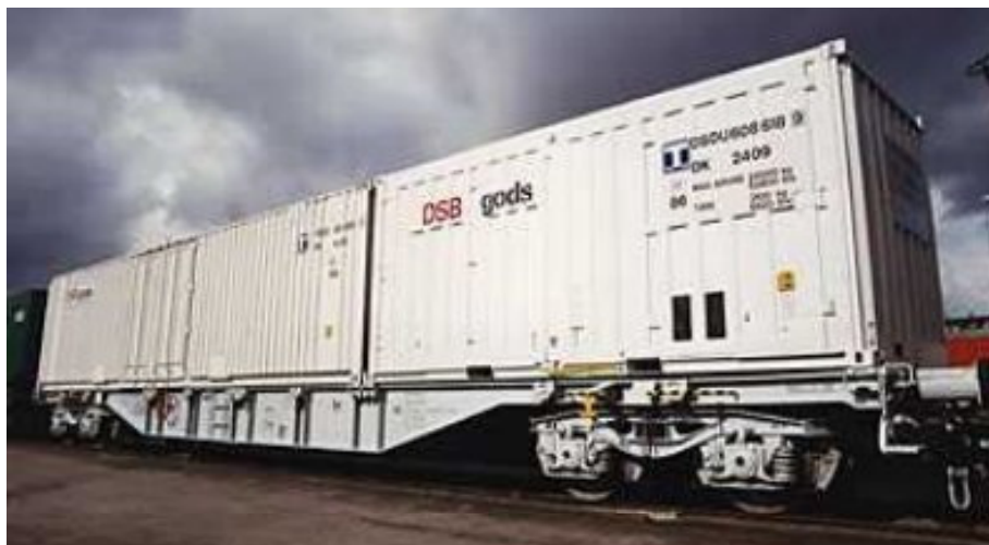
Figur: Boggivagn typ Sgnss, avsedd för transport av två växelflak klass C respektive C+ alternativt två containrar klass C eller en lastbärare klass A (Bild: AAE)
