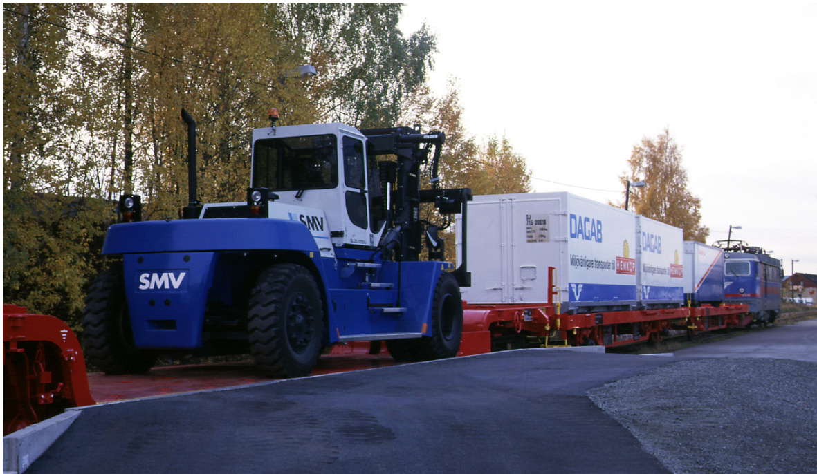
Figur: Lättkombisystemet som kördes av SJ Gods 1998-2001. Lastning och lossning sker under kontaktledning med hjälp av gaffeltruck som följer med tåget. Lokföraren körde trucken. De flesta terminalerna låg i sidotågväg.
