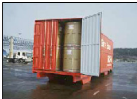
Figur: Stora-boxen med sin bredd på 3,6 m utnyttjar den nya bredare lastprofilen maximalt och är avsedd för kombinerad trafik båt/järnväg.
