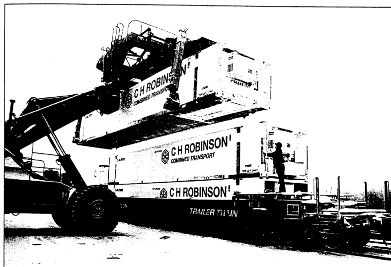
Figur: Triple-stack transport. Containrarna med en höjd på endast 1,9 m är lägre än normalt och kan därför transporteras i de nordamerikanska double-stack-korridorerna. De används för tryckkänsligt gods.
