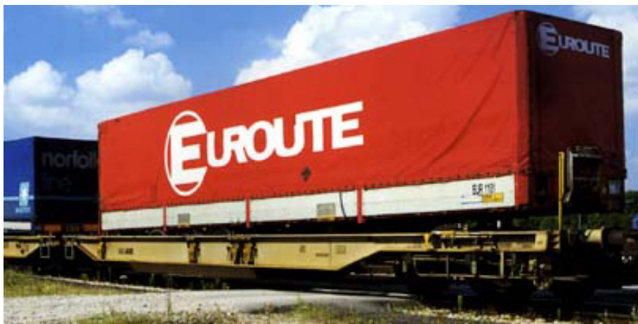
Figur: Ledad kombivagn typ Sdggmrss, som används för transport av två påhängsvagnar eller containrar och växelflak upp till klass A (Bild: AAE)
