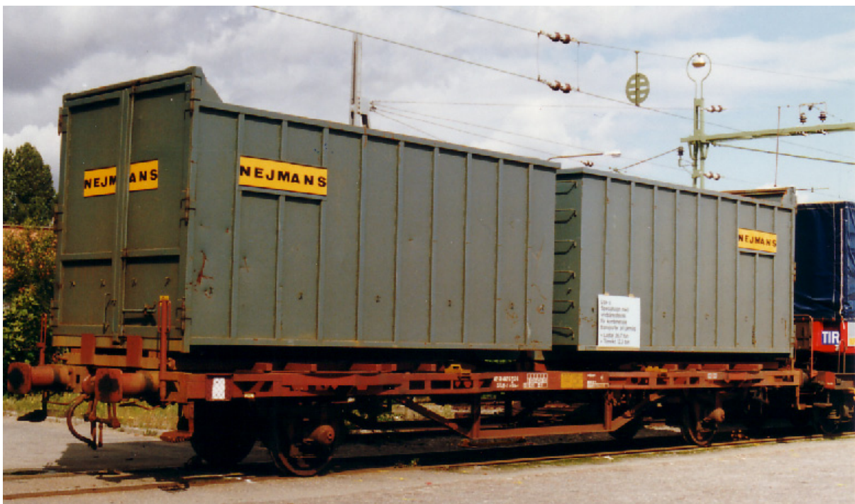
Bild: Järnvägsvagn försedd med vridbara lastramar för rullflakshantering. Vagnen är lastad med två rullflak
