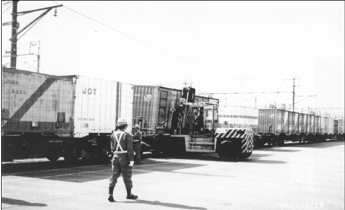
Figur: Linjetårgsbaserat lättkombi-system i Japan, MFFTS (Multi-Functional Freight Track System). Truckarna är stationerade på terminalerna, då dessa hanterar stora volymer. Bilden visar lastningen av containrar under kontaktledning på terminalen i Umekoij nära Kyoto (Foto: J-O Wede).
