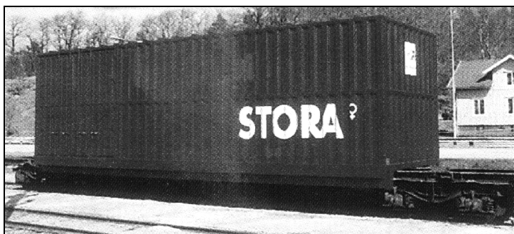
Figur: Stora-boxen med sin bredd på 3,6 m utnyttjar den nya bredare lastprofilen maximalt och är avsedd för kombinerad trafik båt/järnväg.
