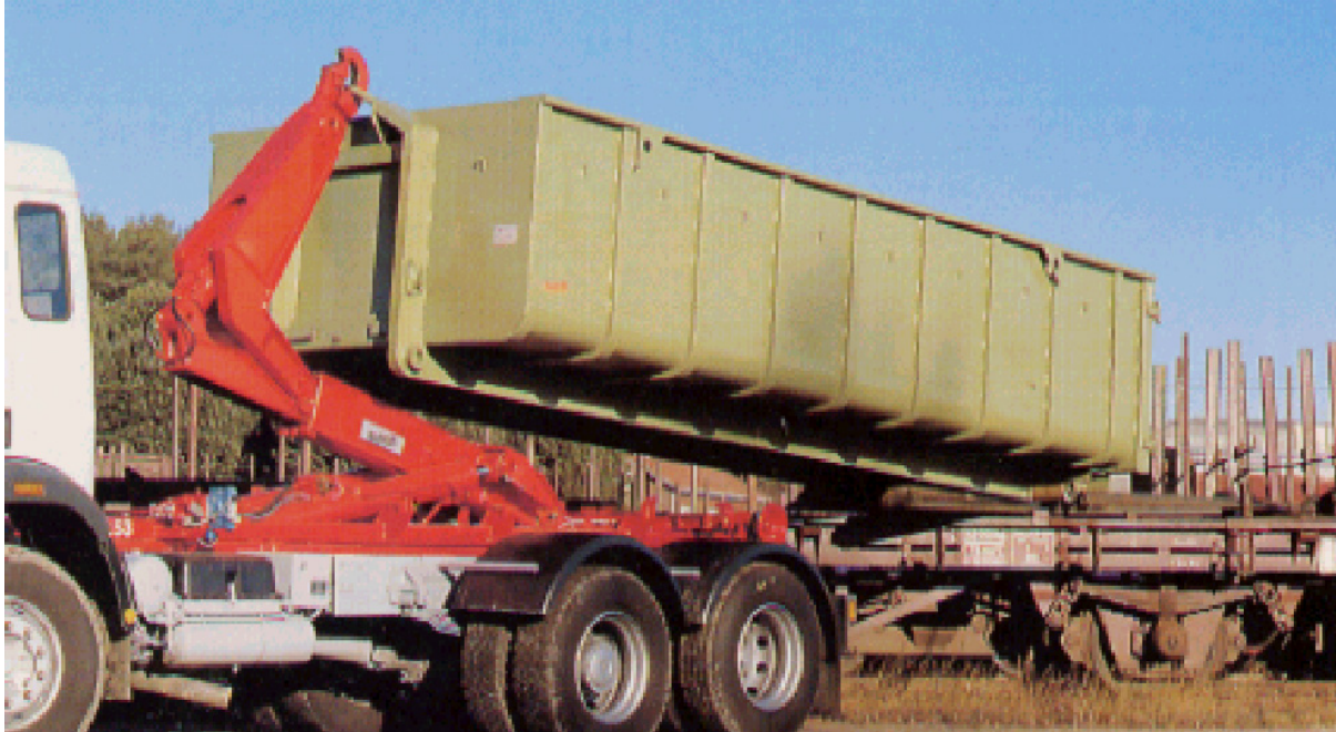
Bild: Direktöverföring av rullflak mellan lastbil utrustad med lastväxlare och järnvägsvagn försedd med vridbar lastram (Bild: Hiab)
