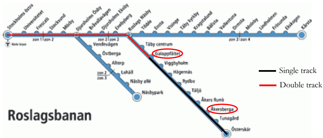
Figure 3.1.2: Existing Roslagsbanan train line. Source: Roslagståg.
