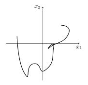
$$\begin{aligned} \dot{x}_1 &= v_1 \\ \dot{x}_2 &= v_2 \\ \dot{v}_1 &= -\omega v_2 \\ \dot{v}_2 &= \omega v_1 \\ \dot{\omega} &= 0 \end{aligned}$$
