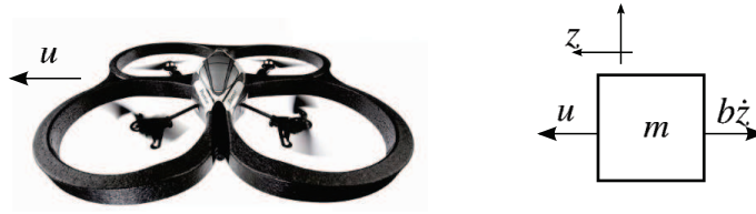
Figur 2: Ett friläggningsdiagram av quadkoptern i uppgift 2 med de modellerade krafterna inritade.
