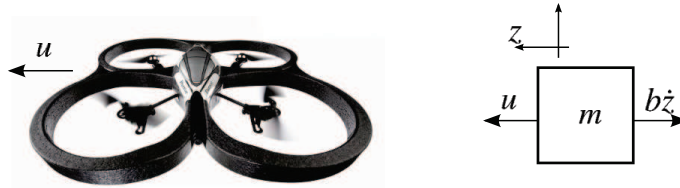
Figur 2: Ett friläggningsdiagram av quadkoptern i uppgift 2 med de modellerade krafterna inritade.
