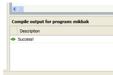
Kompilatorn frågar var den kompilerade bin-filen skall sparas – lägg den i E:\, dvs mbed-modulen. Den blå lysdioden på mbed-modulen kommer då att flimra medan filen laddas ned. När den slutat flimra trycker ni på RESET-knappen för att köra det nedladdade programmet.
