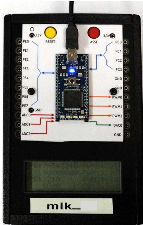
Diverse signaler till/från mbed-modulen är utdragna till 2mm-hylsor. De som är tillgängliga i denna laboration är indikerade nedan.
