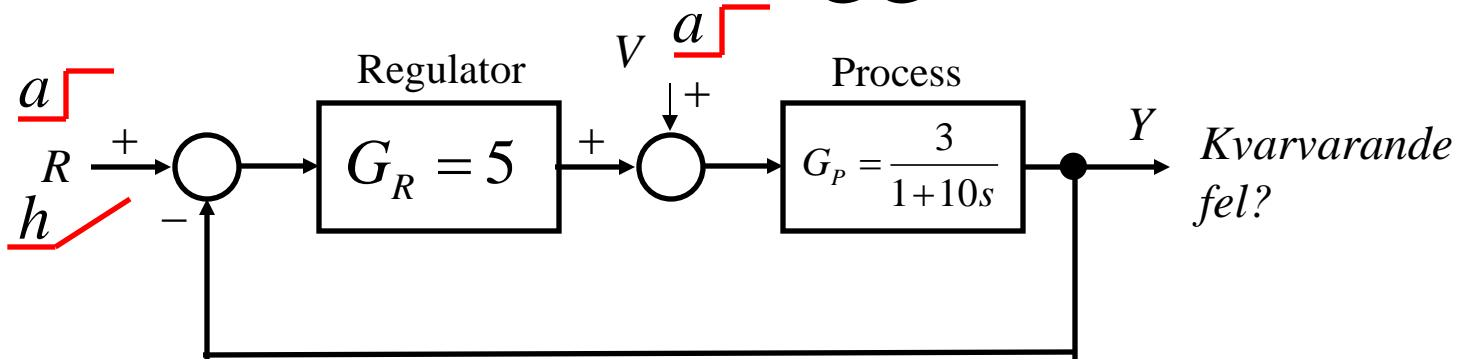
$$a) \frac{Y}{R} \quad e_0 = ? \quad b) \frac{Y}{R} \quad e_1 = ? \quad c) \frac{Y}{V} \quad e_V = ?$$
