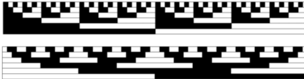
För linjär rörelse används kodlinjaler. Överst binärkodad eller nederst Graykodad.
