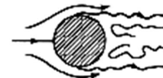
Laminar boundary layer wide turbulent wake (D)
