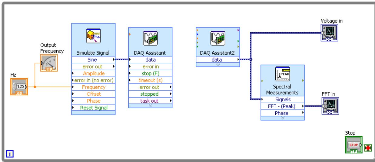
"Simulate Signal" ska vara inställd nästan som tidigare (se tidigare figur, men ändra "samples per second" till 100k), detta görs i "properties".
