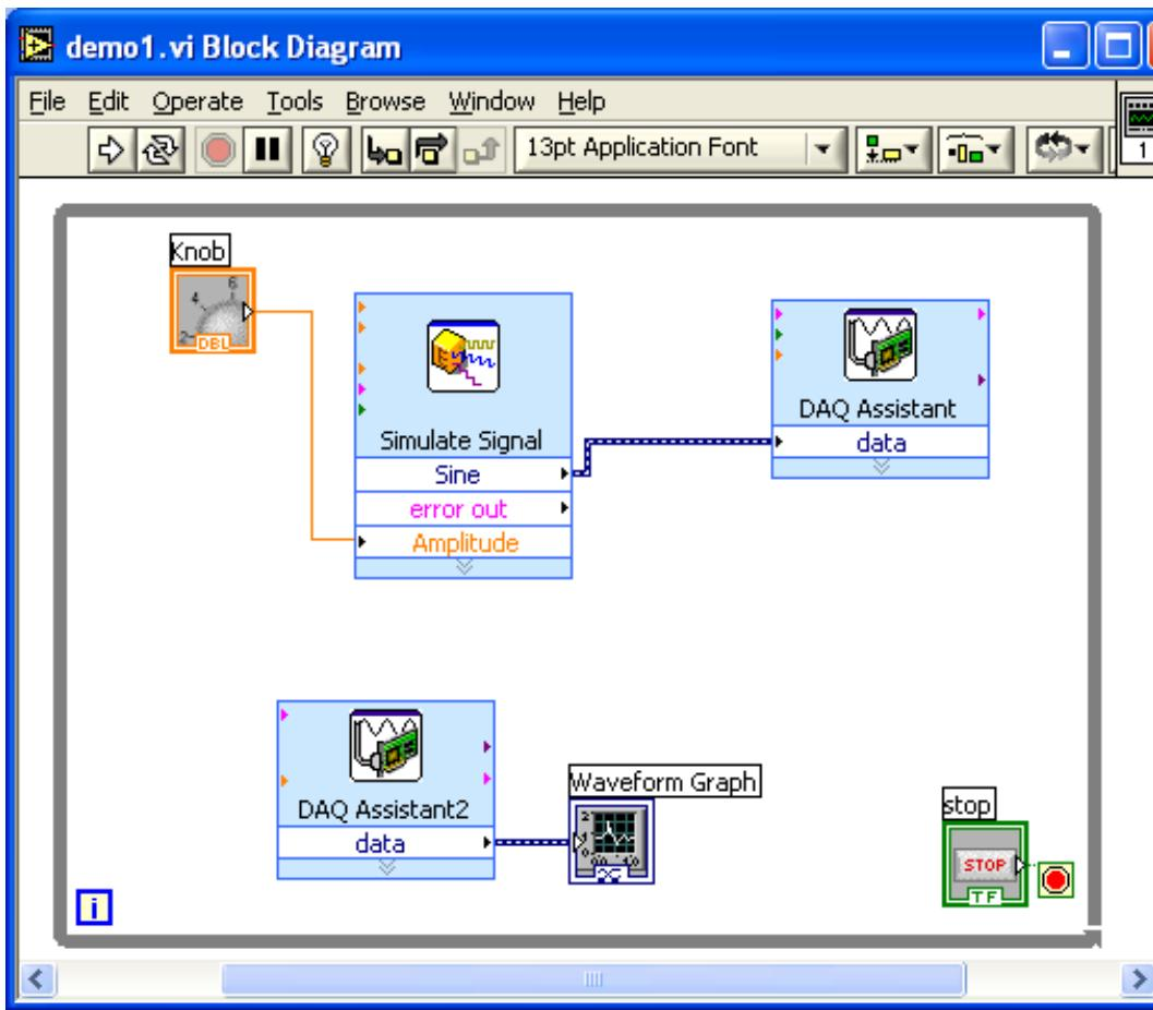
Ovanstående figur visar blockschemat och där finns blocket "simulate signal" vars amplitud styrs från blocket "knob". "simulate signal" blocket skickar en signal till "DAQ Assistant" blocket. "DAQ Assistant" blocket skickar ut signalen på en analog utgång, en D/A-omvandlare (Digital till analogomvandlare). Signalen som blir en spänningen och kan mäts med voltmeter eller scopemeter.
