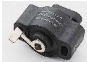
Resistiv vinkelgivare, sk. Trottelpotentiometer. Används tex för att mäta gaspedalens läge i personbilar.
