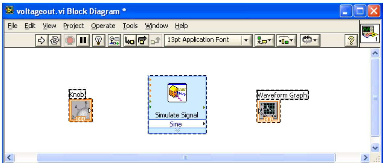
I blockschemat finns nu tre block, Knob, Simulate signal och Waveform Graph. Greppa nederkanten på "Simulate Signal" och dra nedåt och släpp. Syns ingången "Amplitude" så har ni dragit tillräckligt långt. Det är dags att dra ledningar mellan blocken. Flytta
