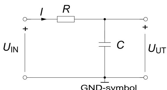
Kretsen kopplas upp på 10-plinten och du ska använda dessa komponenter:  $R = 30 \text{ k}\Omega$  och  $C = 470 \text{ nF}$ .
