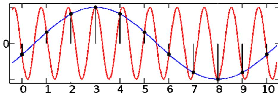
Den blåa kurvan rekonstruerar en signal utifrån samplingsvärdena med en frekvens som i detta fall är  $1/9$  av den riktiga – den röda kurvan har alltså vikts till en lägre frekvens.
