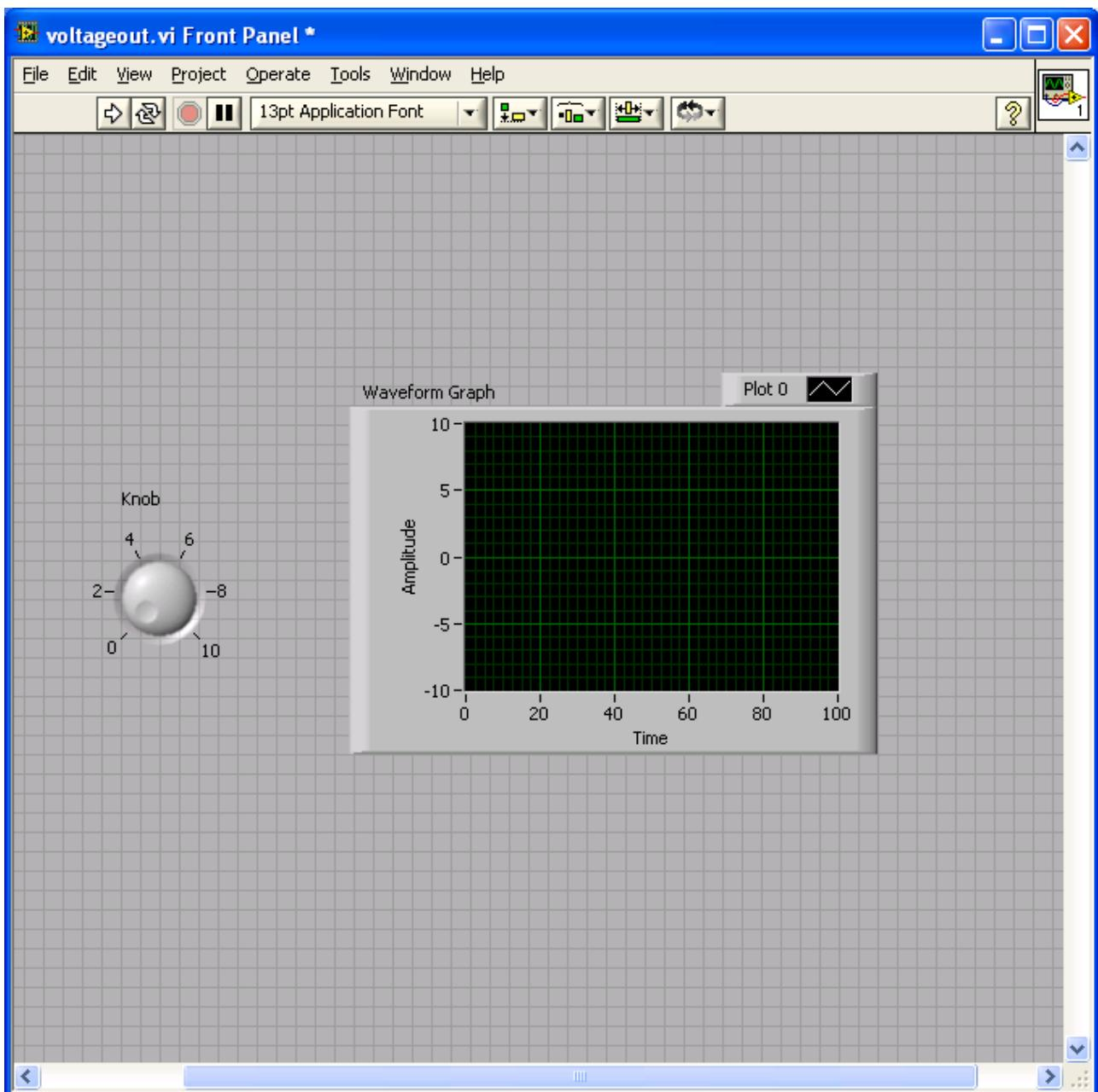
Kontrollera att dessa även återfinns i blockschemat genom att byta till detta fönster. Nu ska vi lägga in en signalgenerator i blockschemat och göra de nödvändiga kopplingarna (tråddragningar).
