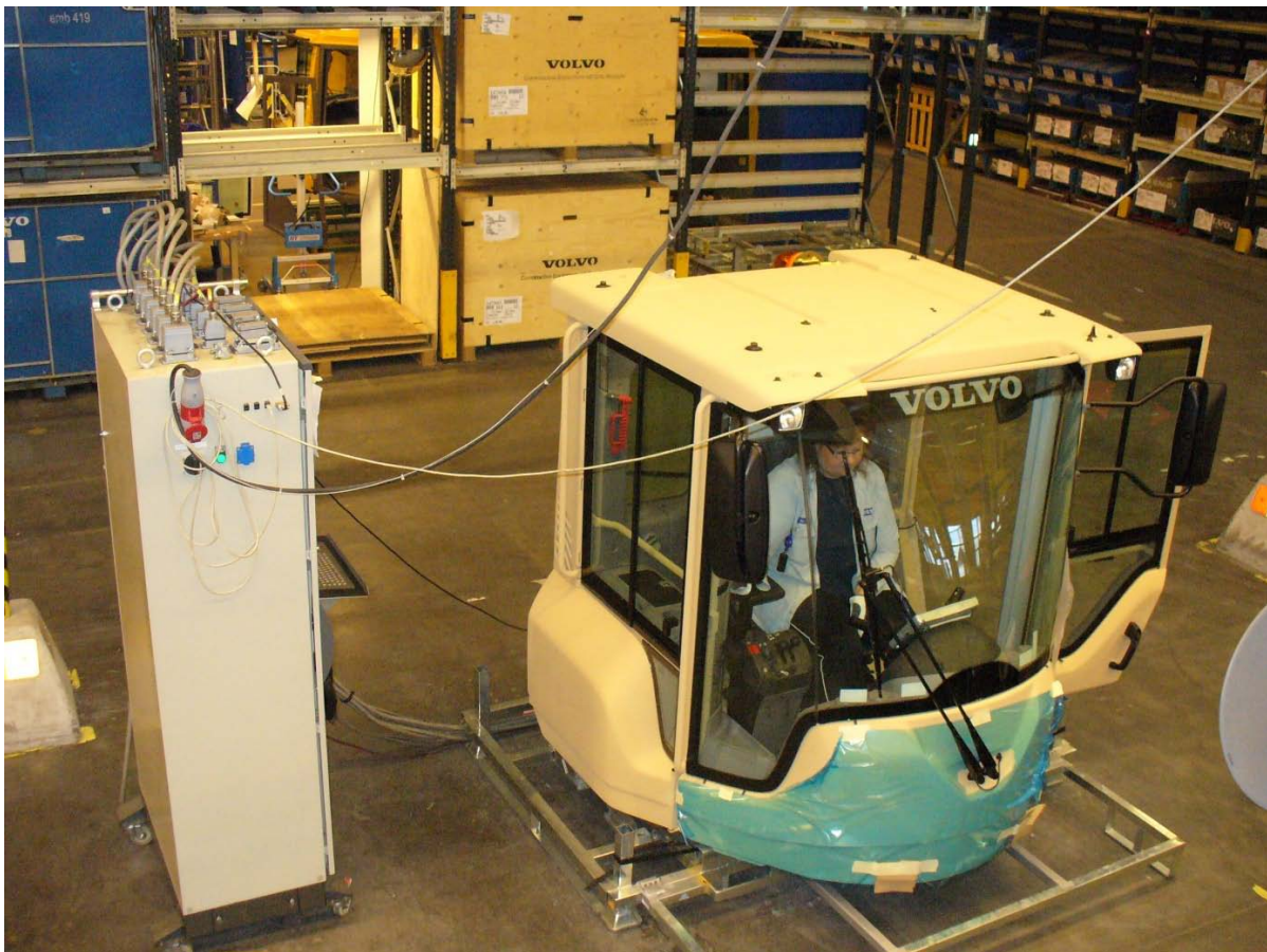
Figur 3 - Funktionstest av Hytt Volvo, CE Hallsberg
