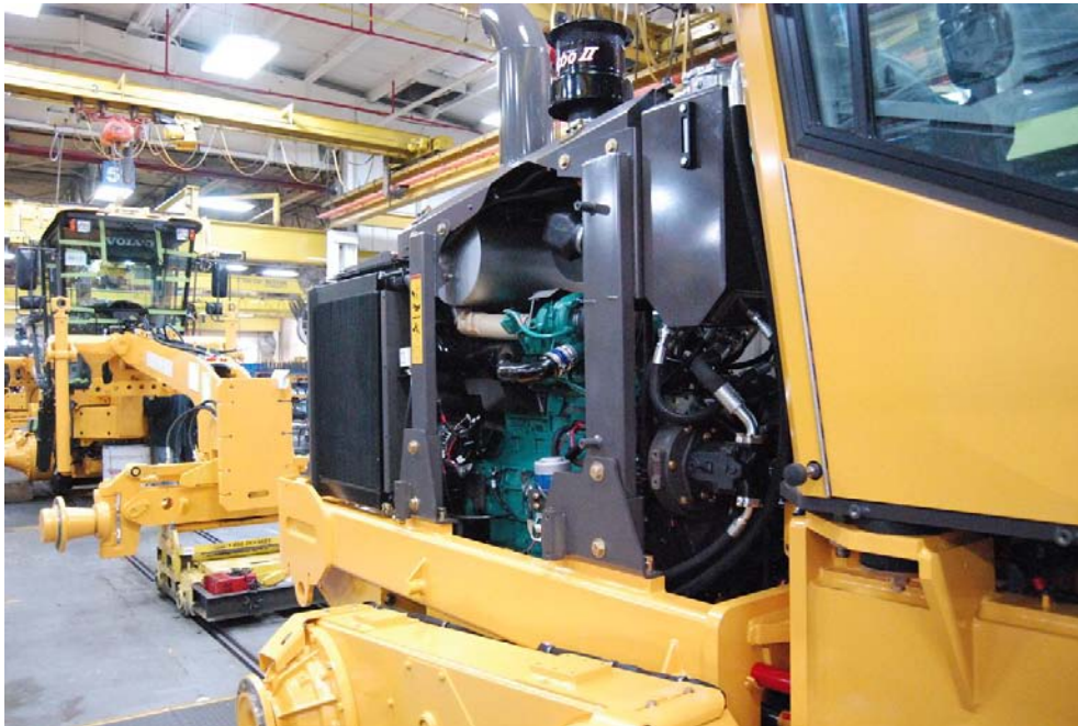
Figur 14 – Motormodul monterad på väghyvel
