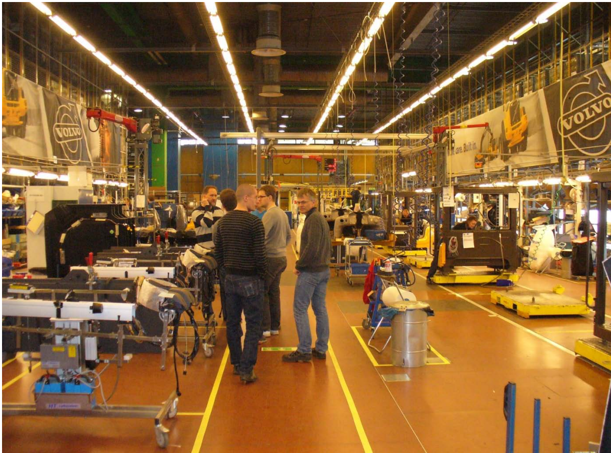
Figur 16 - Montering hytt Volvo CE Hallsberg - Variansskapande delmontering till vänster, hyttline till höger
