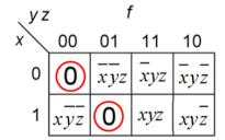
$$f(x, y, z) = \{PoS_{Maxterms}\} = (x + y + z) \cdot (\overline{x} + y + \overline{z})$$
