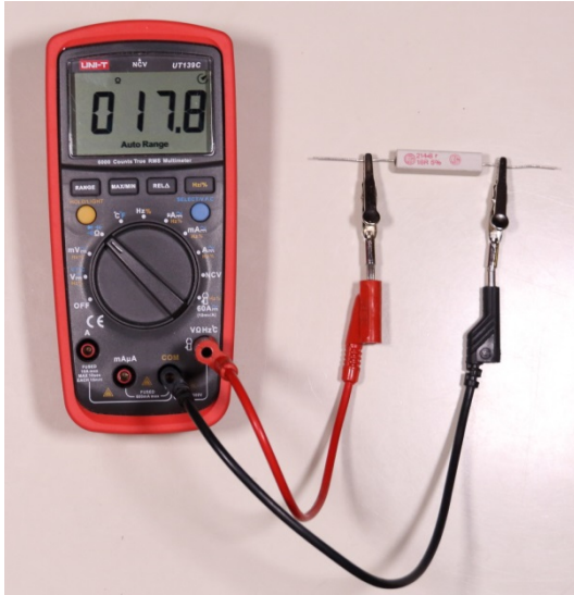
Figur 4. Mätning av resistans
