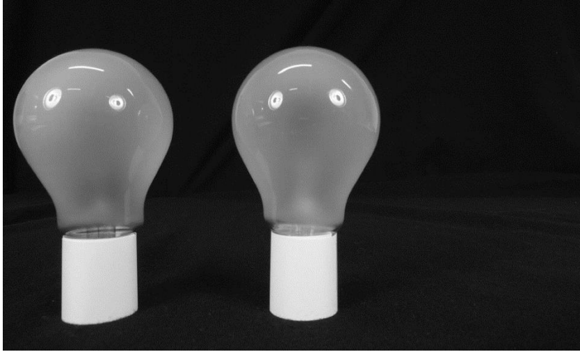
Fig. 7.4. Bild av två glödlampor tagen med vidvinkelobjektiv. Glödlampan närmast bildkanten ser deformerad ut beroende på ett perspektivistiskt fel som uppstår när bilden betraktas på felaktigt avstånd. Vid korrekt betraktningsavstånd, i detta fall ca. 7 cm, så försvinner felet. En förklaring till hur fenomenet uppstår ges i Fig. 7.5.
