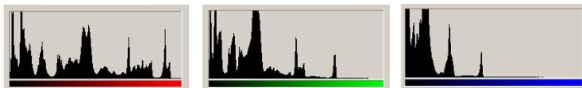
Fig. 13.10. RGB-histogram för bild av samma motiv som i Fig. 13.9, men i detta fall är vitbalansen felaktigt inställd. Rödkanalen är korrekt exponerad, medan grönkanalen är lite underexponerad och blåkanalen är mycket underexponerad.
