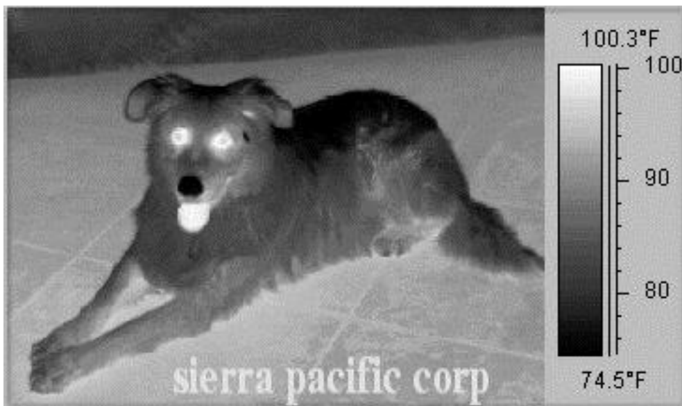
Fig. 25.1. Termovisionsbild av en hund. Olika temperaturer återges med olika gråtoner enligt skalan till höger ( 100^\circ\text{F} = 38^\circ\text{C} ). Notera den höga temperaturen på ögon och tunga. Nosen är däremot kall.
