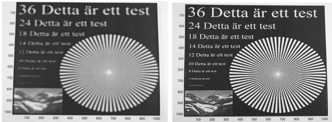
Fig. 17.39. Vänstra figuren visar en bild som erhållits då optiken varit felfokuserad. Bilden är allmänt suddig, och för vissa tätheter i "ekermönstret" försvinner kontrasten helt för att sedan återuppstå (men då har vita och svarta linjer bytt plats). Högra figuren visar samma bild efter avfaltning. Förutom att skärpan är mycket bättre, så ligger svarta och vita linjer på sin rätta plats. Vid linjetätheter där den vänstra figuren helt saknar kontrast kvarstår av naturliga skäl vissa felaktigheter. (Bildmaterialet har erhållits från Anna Burvall och Peter Unsbo.)
