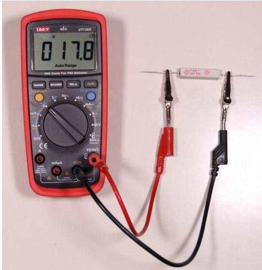
Figur 4. Mätning av resistans
