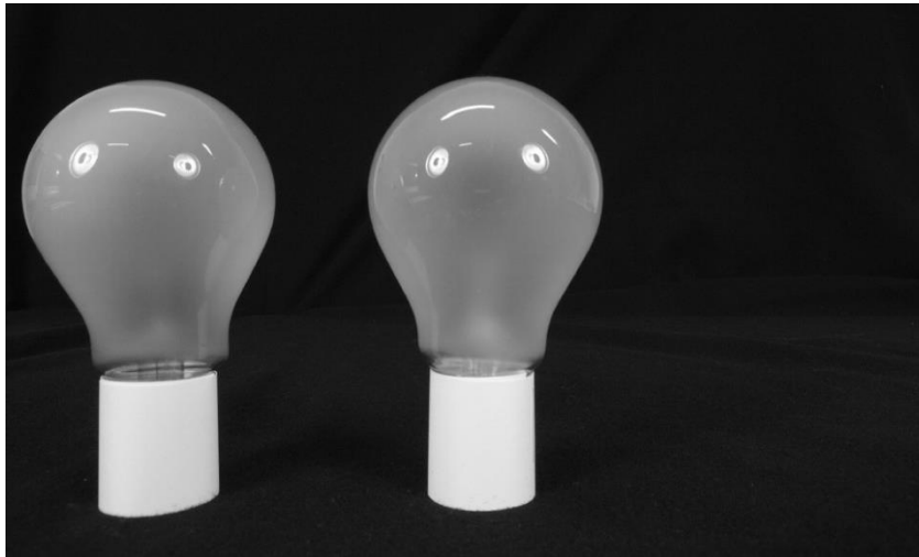
Fig. 7.4. Bild av två glödlampor tagen med vidvinkelobjektiv. Glödlampan närmast bildkanten ser deformerad ut beroende på ett perspektivistiskt fel som uppstår när bilden betraktas på felaktigt avstånd. Vid korrekt betraktningsavstånd (ca. 6 cm om bildbredden är 10 cm på en datorskärm) så försvinner felet. En förklaring till hur fenomenet uppstår ges i Fig. 7.5.
