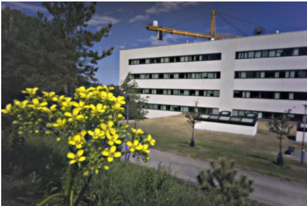
Fig. 2.5. Bild tagen med hålkameran i Fig. 2.4. Skärpedjupet blir extremt stort på grund av det lilla hålet. De gula blommorna ("Ryssgubbe") är ca. 8 mm i diameter, och befinner sig ca. 9 cm framför kameran. Bilderna blir också helt distorsionsfria. Distorsion är annars ett utpräglat problem för vidvinkelobjektiv.
