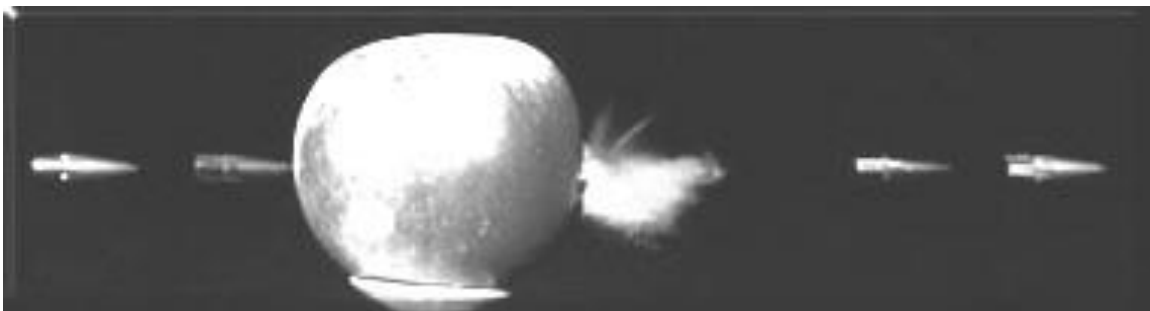
Fig. 21.2. Fotografi som visar hur en gevärskula med hastigheten 800 m/s genomtränger ett äpple. Bilden togs med en vanlig kamera vars slutare var öppen under hela exponeringsförloppet. Som ljuskälla användes ett blixtaggregat som gav ca. 0.5 \mu s långa blixstar som upprepades med ca. 100 \mu s tidsintervall.
