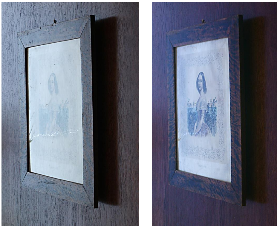
Fig. 5.15. Exempel på effekten av polarisationsfilter. Motivet är belyst med dagsljus som infaller snett från vänster. Vänstra bilden utan polarisationsfilter, den högra med filter.
