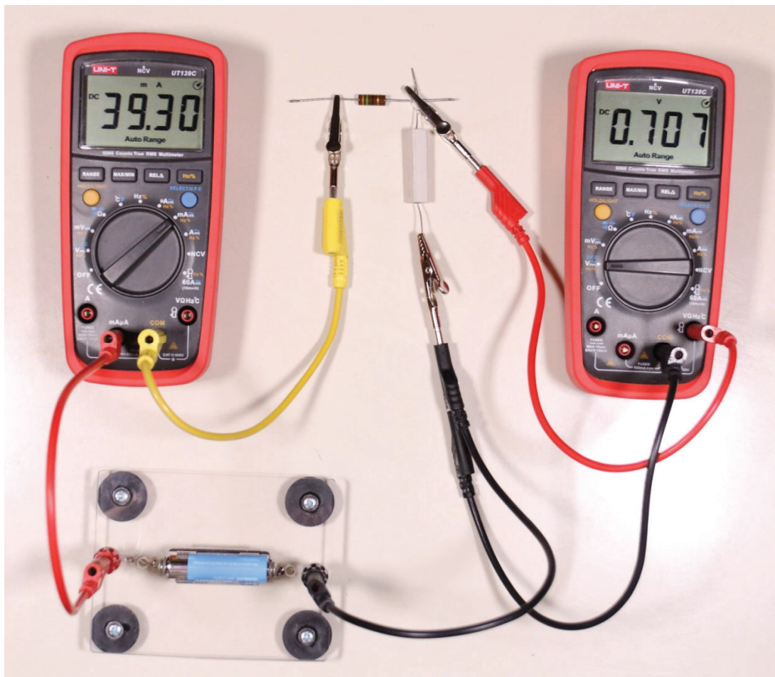
Figur 7. En krets med ett batteri, två motstånd och två multimetrar.
