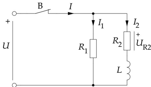
b) Strömmen  $I_1$  slutar omedelbart att flyta då strömbrytaren B öppnas. Strömmen  $I_2$  kommer på grund av induktansen  $L$  att bibehålla sitt värde för att avklinga mot 0A med tidkonstanten  $L/R = 0,815/(880+400) \text{ s} = 0,637 \text{ ms}$ . Med figurens beteckningar kommer  $I_1$  att bli  $= -I_2$ .
