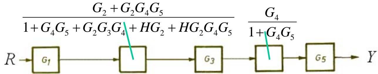
$$G_1 \cdot \frac{G_2 + G_2 G_4 G_5}{1 + G_4 G_5 + G_2 G_3 G_4 + HG_2 + HG_2 G_4 G_5} \cdot G_3 \cdot \frac{G_4}{1 + G_4 G_5} \cdot G_5$$
