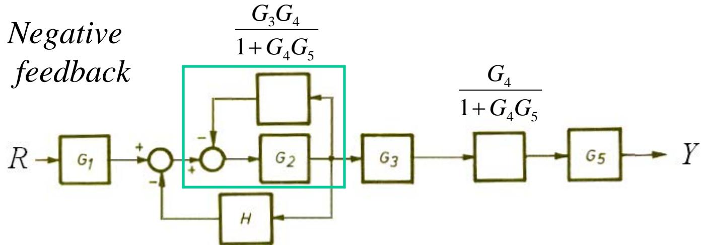
$$\frac{G_2}{1 + \frac{G_2 G_3 G_4}{1 + G_4 G_5}} = \frac{G_2 + G_2 G_4 G_5}{1 + G_4 G_5 + G_2 G_3 G_4}$$
