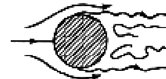
Laminar boundary layer wide turbulent wake (D)
