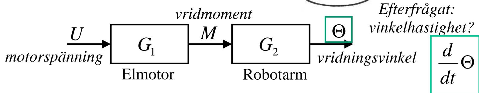
Vad blir robotarmens sluthastighet i sorten **varv/minut** [rpm] om ett spänningssprång  $U = 6$  [V] läggs på motorn?
