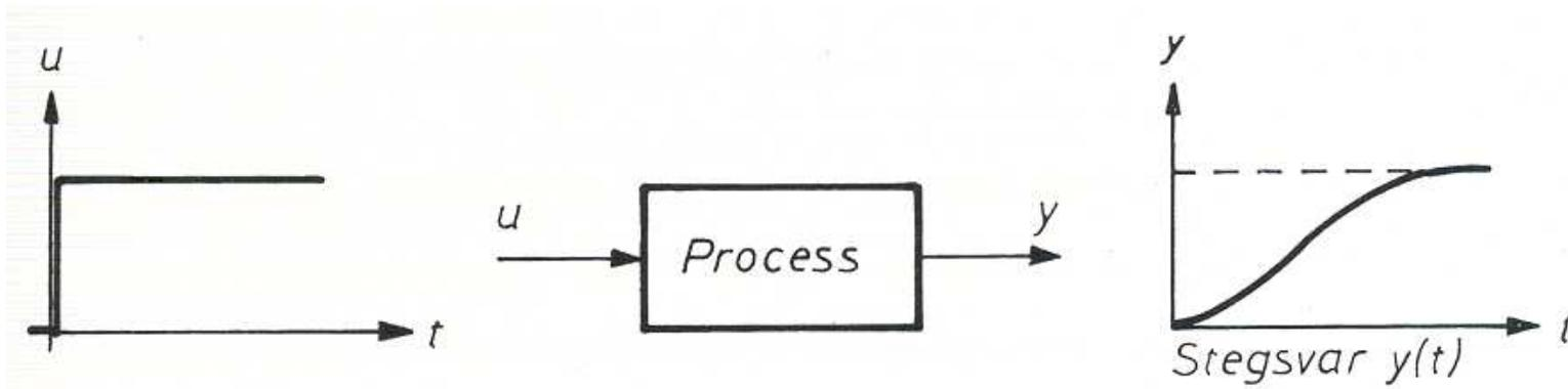
Enhetssteget är den vanligaste "testsignalen".
