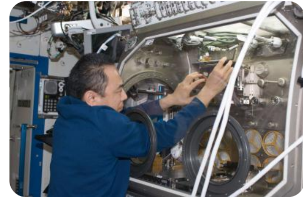
Astronaut Furukawa installing SODI COLLOID In the MSG
