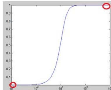
Delningsfiltret är till diskanthögtalaren. Det går att konstruera ett liknande filter till båshögtalaren så att den totala impedansen (diskant + bas) blir konstant =  $R$  för alla frekvenser – men detta är en annan historia ...
