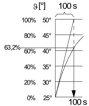
Om det *inte* skulle vara samma födröjning från båda temperaturgivarna, utan rumstemperaturgivaren vore "snabbare", kan det bli problem. Antag att utrustningen tas in från minusgrader till rumstemperatur, batteriet skulle då hinna bli **överladdat** och **förstört** innan batteritemperaturgivaren skulle nå över rumstemperaturgivaren!
